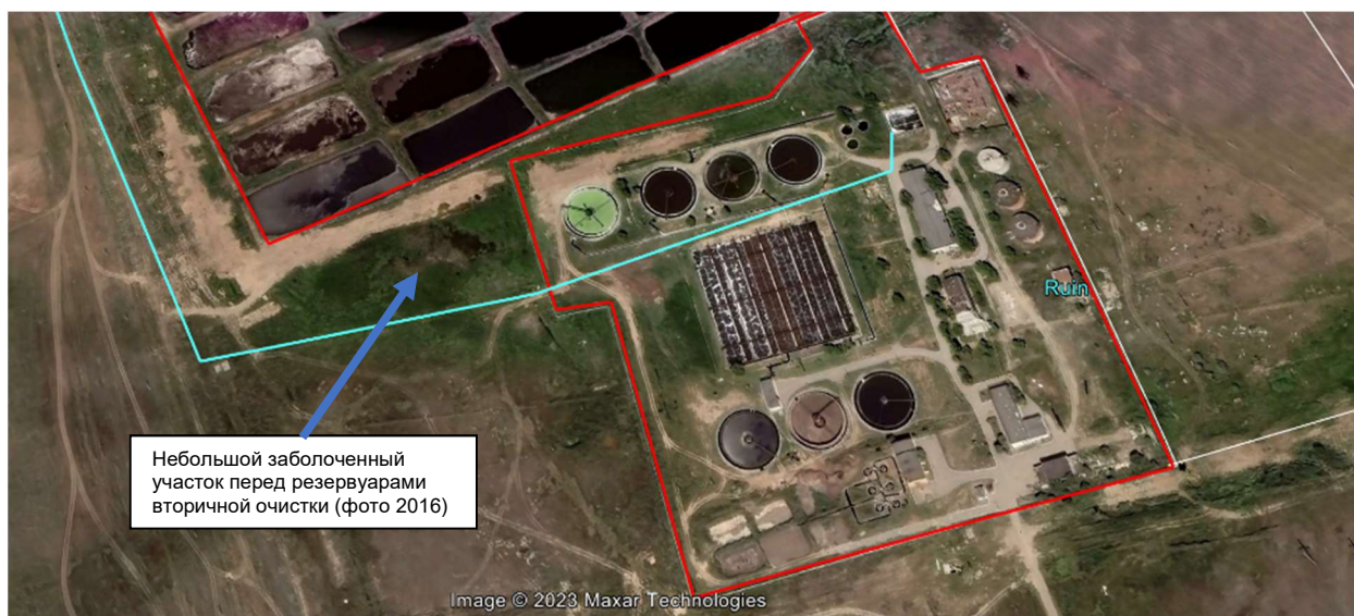
Рис. 6.23 Аэрофотоснимок 2016 г., показывающий заболоченные участки выше по течению от вторичных отстойников. В 2018 году был прорыт дренажный канал для осушения образовавшегося болота (источник карты: Google Earth, аэрофотоснимок 8/2016)
