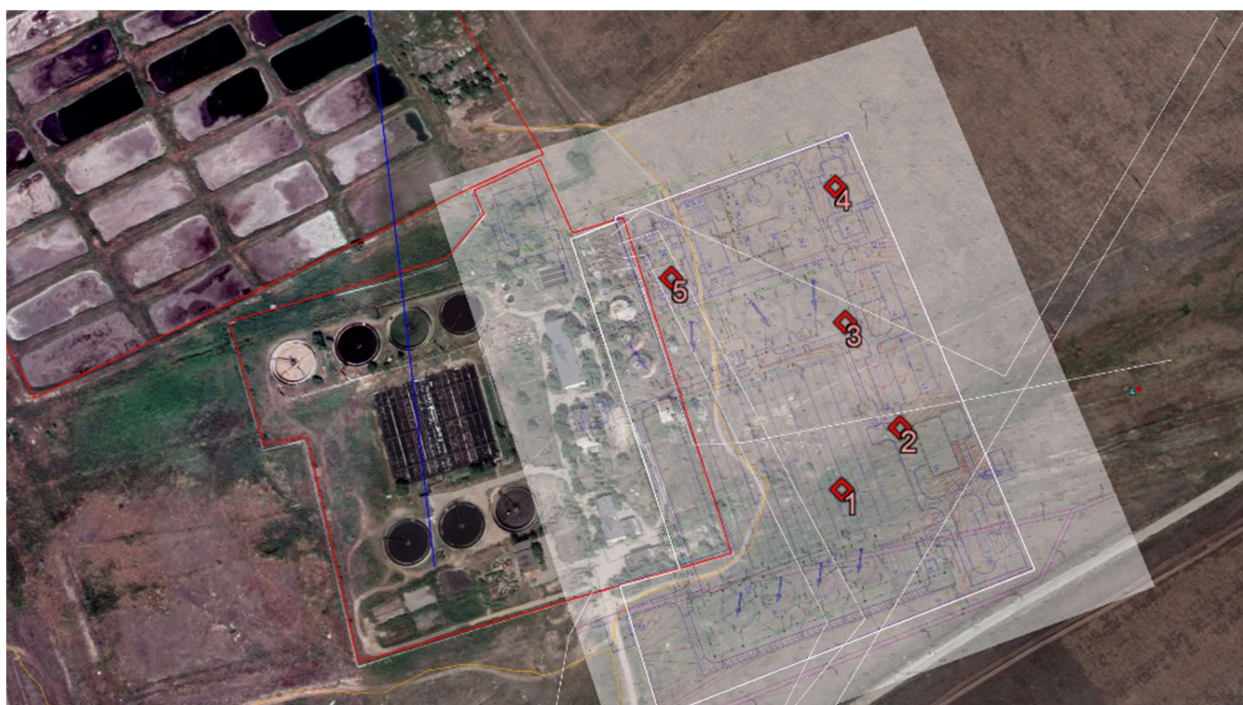
Рис. 6.9: Места отбора проб почвы, взятых на площадке предполагаемого КОС. Точки отбора проб: 1 – низина под планируемыми азротенками; 2 – низина у планируемого фундамента мастерской-гаража; 3 – дренажный канал на краю сенокосного поля вблизи планируемых вторичных отстойников; 4 – сенокосное поле под планируемый цех обеззараживания; и 5 – пустырь под планируемые анаэробные метантенки.
