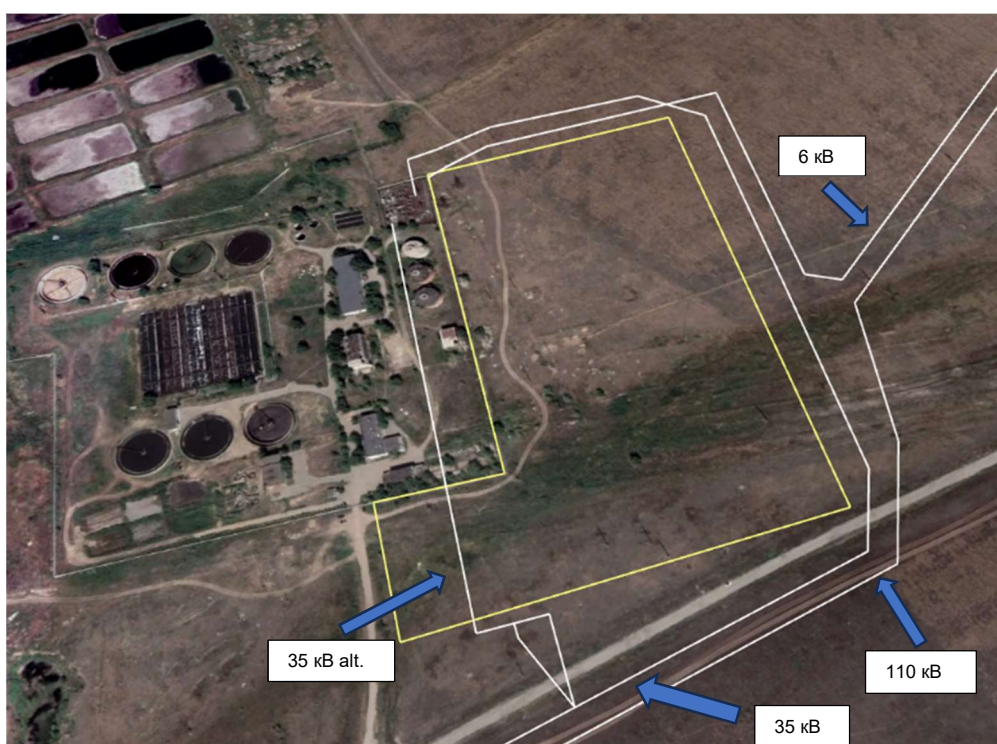
Рис. 3.7 Предлагаемое перемещение воздушных линий электропередач
