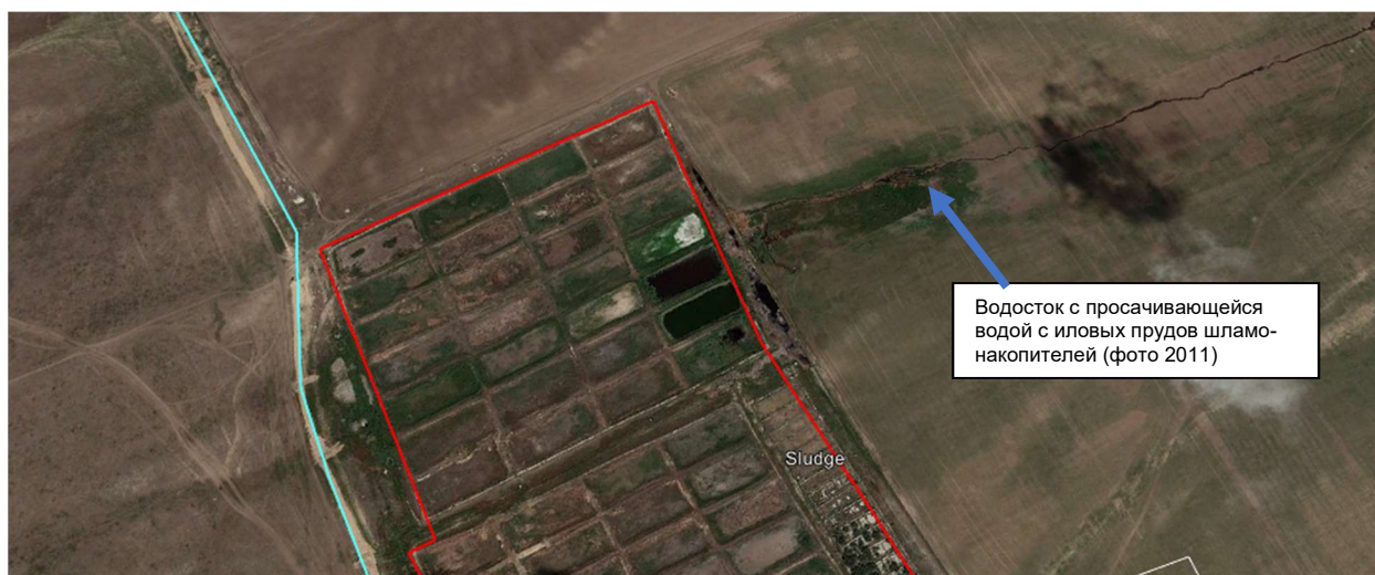
Рис. 6.24 Аэрофотоснимок 2011 г., показывающий образование оврага с водой с иловых прудов, просачивающейся на близлежащие поля и на восток.
