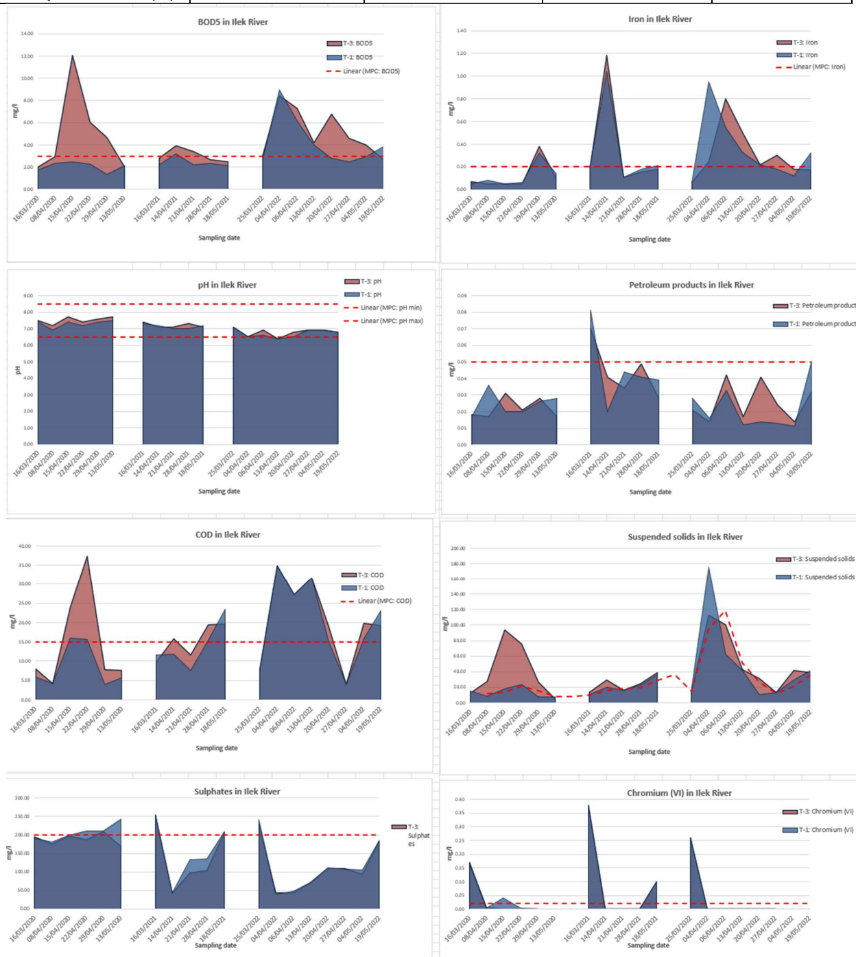
Рис. 6.32: Графики, показывающие замеры в резервуаре УРЕ в зависимости от ПДК (красный пунктир) в 2020-2022 гг. по параметрам: БПК 5 , Железо, pH, Нефтепродукты, ХПК, Взвешенные вещества, Сульфаты, Хром (VI). Синяя область отражает Т-1 (выше сброса из УРЕ) и красная Т-3 (ниже сброса из УРЕ).
