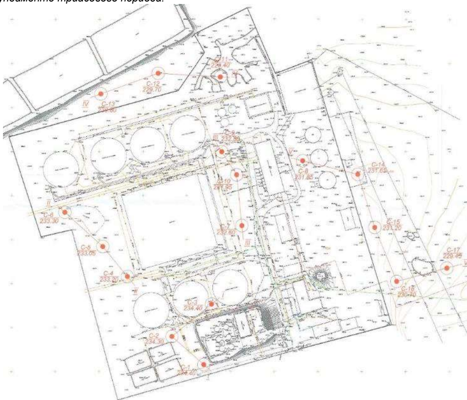
Рис. 6.8 Скважины, пробуренные в рамках геотехнической оценки, выполненной «Геопроект Актобе» в 2016 году. 17 скважин, пробуренных на существующем КОС, и на участке, запланированной для нового КОС к востоку от нее (Источник: Геотехнический отчет Геопроект Актобе, 2016 г.)
