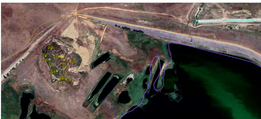
Рис. 6.35: Точки отбора проб осадка (желтые точки) в пределах площадки длительного хранения осадка к северу от резервуара УРЕ.
