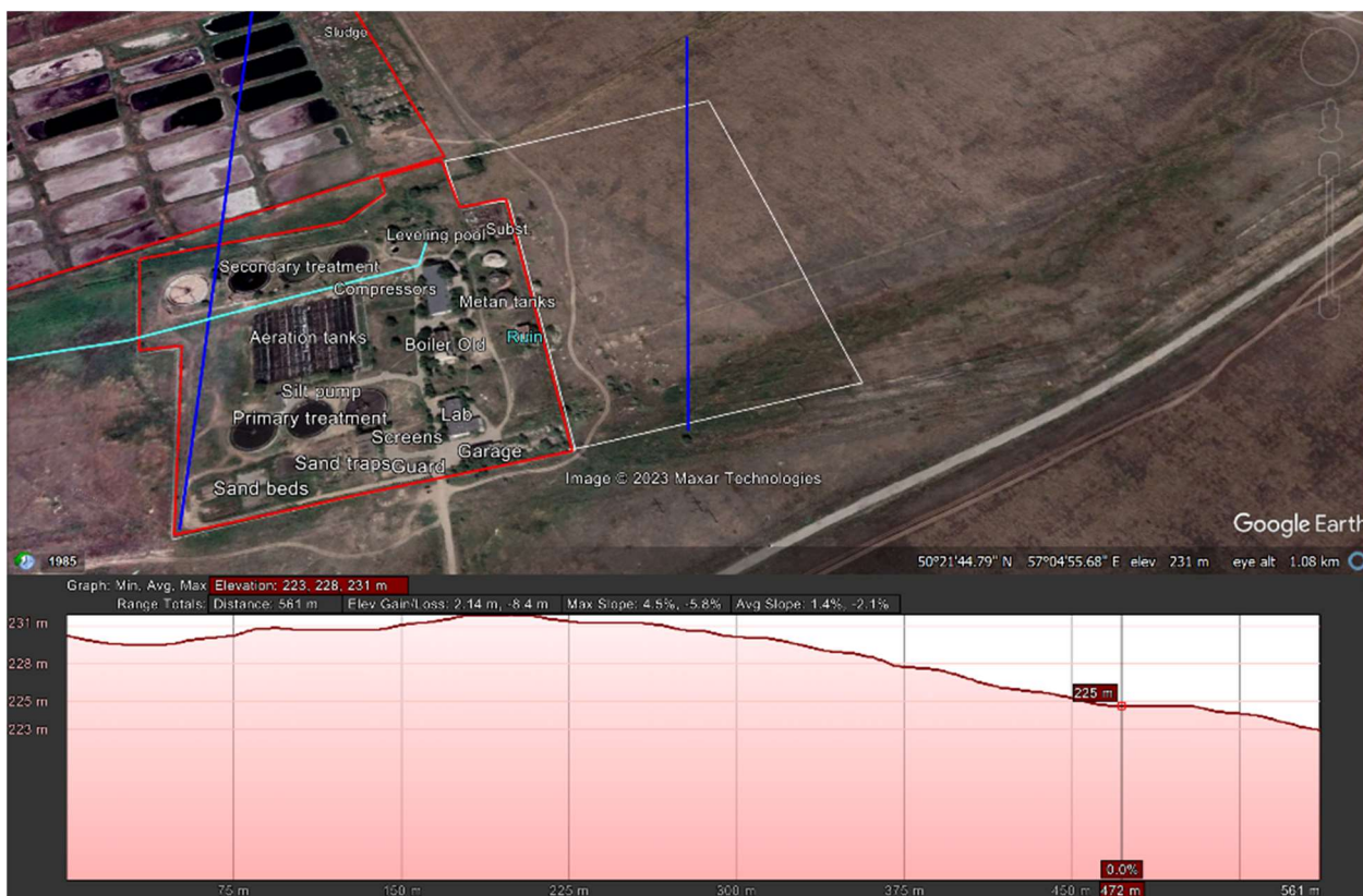
Рис. 6.2: Топография разреза север-юг (правая синяя линия) площадки нового Актыбинского КОС (Источник: Google Earth)
