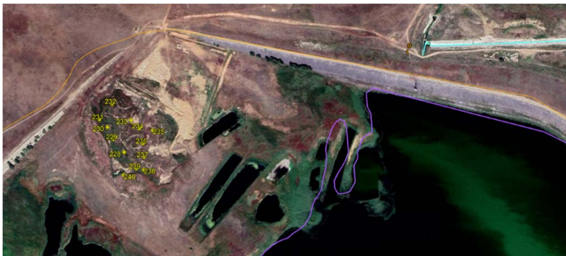
Сурет 6.32: URE резервуарының солтүстігіндегі ұзақ мерзімді тұнба қоймасының аумағындағы тұнба сынамаларын алу нүктелері (сары нүктелер).
