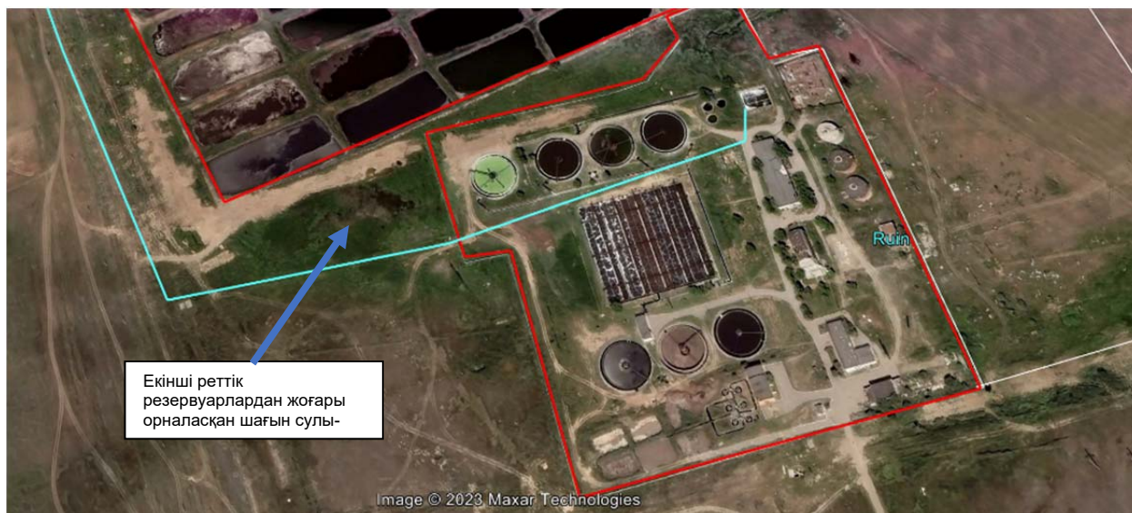
Сурет 6.20 2016 жылғы аэрофотосуретте екінші реттік тұндырғыштардан жоғары орналасқан сулы-батпақты жерлер көрсетілген. 2018 жылы пайда болған батпақты ағызу үшін дренаждық канал қазылды (карта көзі: Google Earth, 8/2016 жылғы аэрофотосурет)
