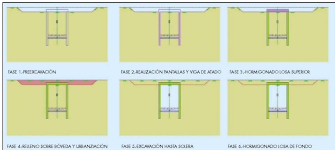
Ilustración 7-14 Fases de ejecución del túnel por el método Cut and Cover
