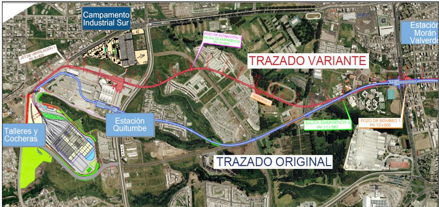
Ilustración 7-1 Trazado de la Variante Quitumbe de 2.6 km., de la Primera Línea del Metro de Quito
