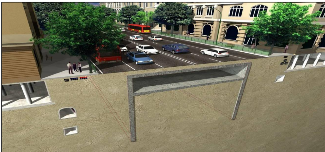
Ilustración 7-18 Excavación bajo losa (I)
