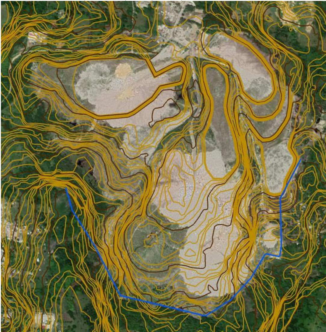
Figura 3.9.a Ubicación de canaleta perimetral para captación pluvial
