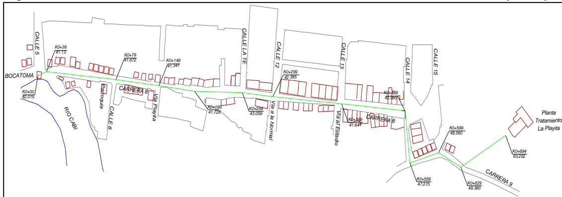
Figura 3.4. Conducción Bocatoma río Cabí a la Planta de Potabilización La Playita I y II
