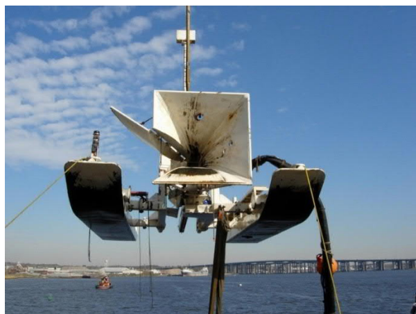
Figuur 4-20: Prysmian Hydroplow Jetting trencher
