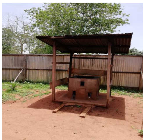
Photo 4 : Incinérateur non conforme aux normes de l'OMS du Centre Privé Saint Basile de Berberati
