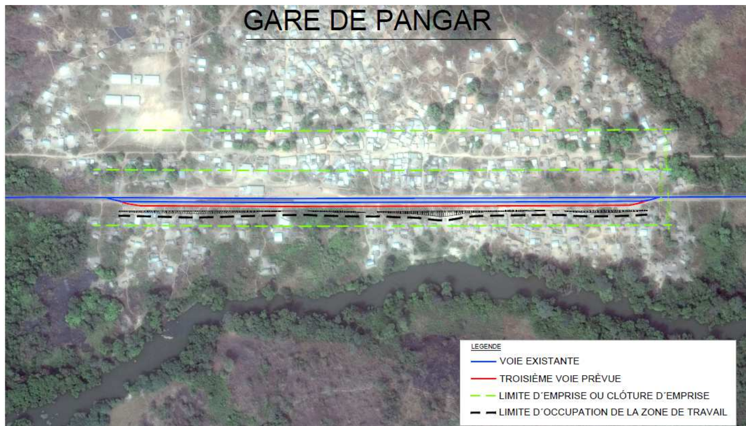
Figure 4 : Gare de Pangar. Extension à une troisième voie
