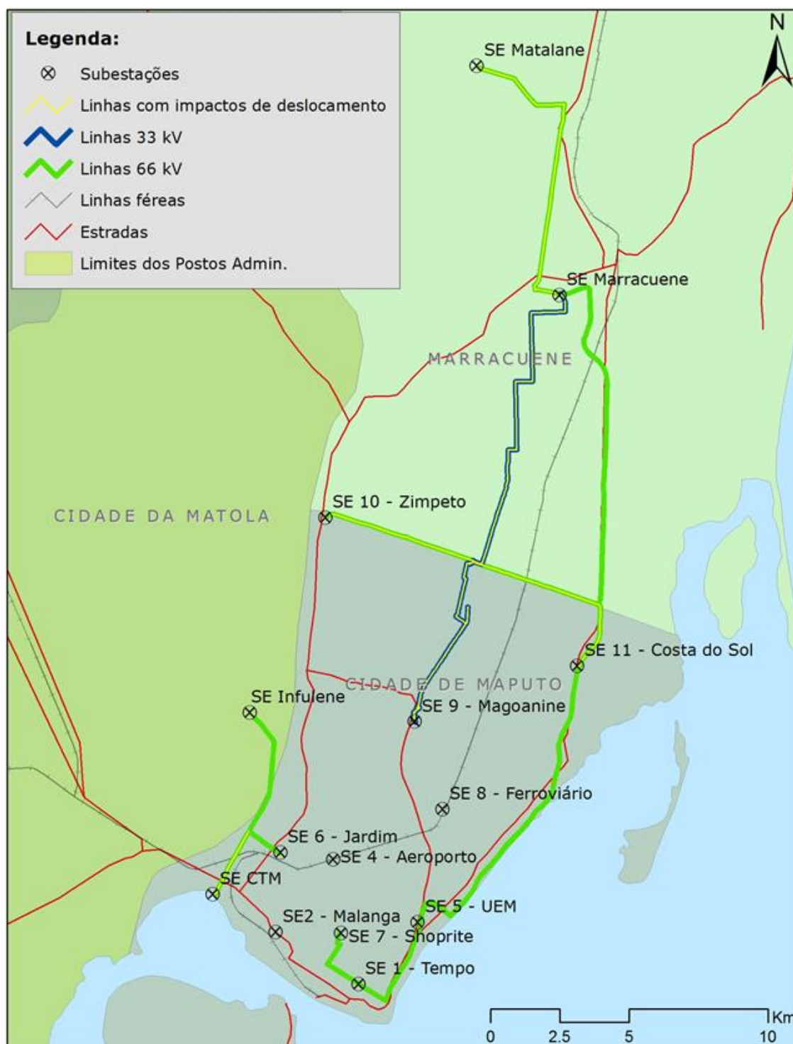
Figura 2-1: Linhas de 66 kV (em verde) e 33 kV (em azul) cobertas pelo Plano e indicação daquelas com impactos de deslocamento (sobreposição em amarelo)
