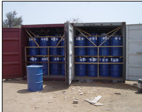
Figure 21 : stockage en conteneurs des fûts contenant les pesticides reconditionnés sur des palettes Source : FAO
