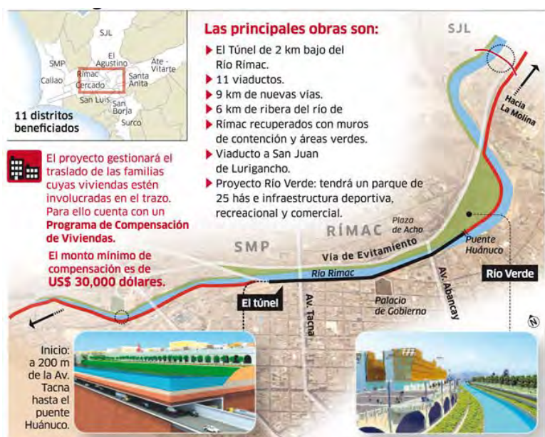
Figura 6.5 Project Vía Parque Rímac
