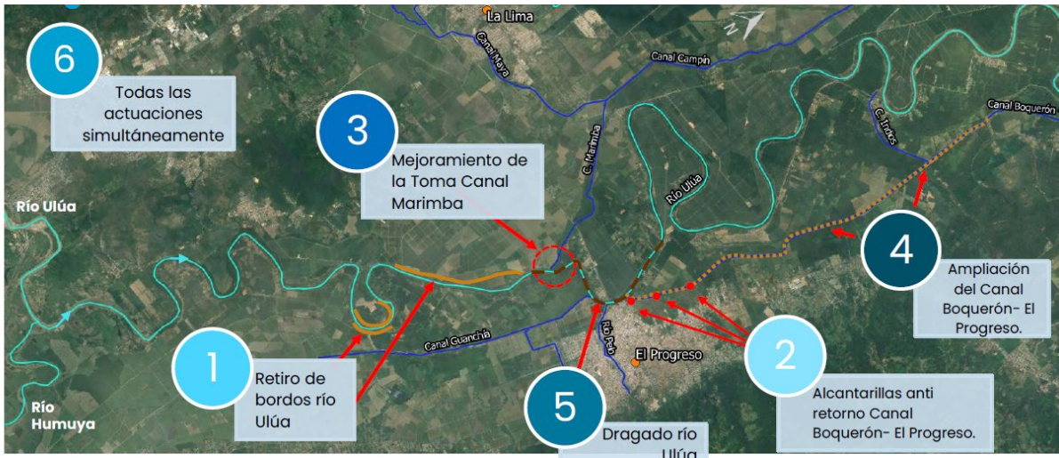
Actuaciones propuestas con sentido hidráulico Río Ulúa
