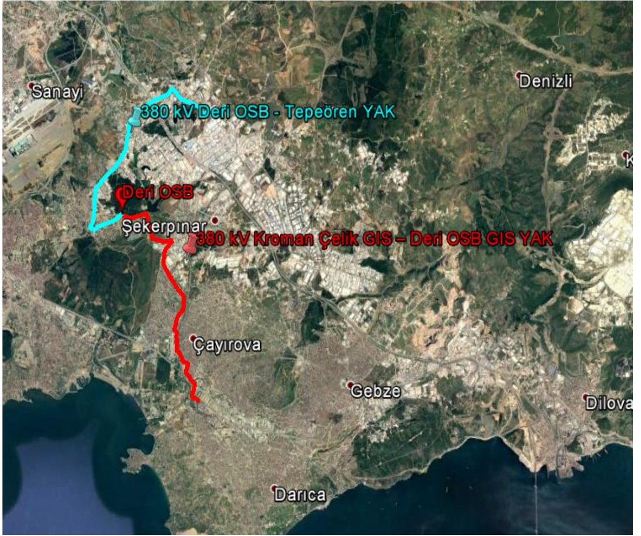
Şekil 3 Deri OSB GIS TM'ye Bağlanacak Yer Altı Kablolarını Gösterir Uydu Görüntüsü-2
