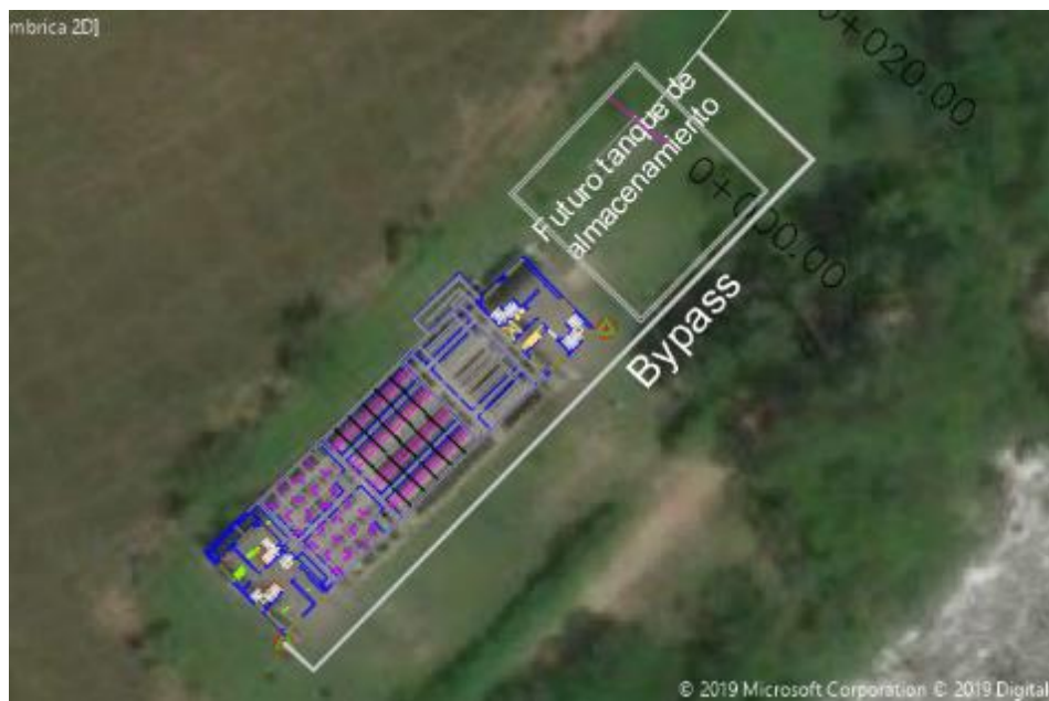
Figura 16. Bypass y futuro tanque de almacenamiento.
