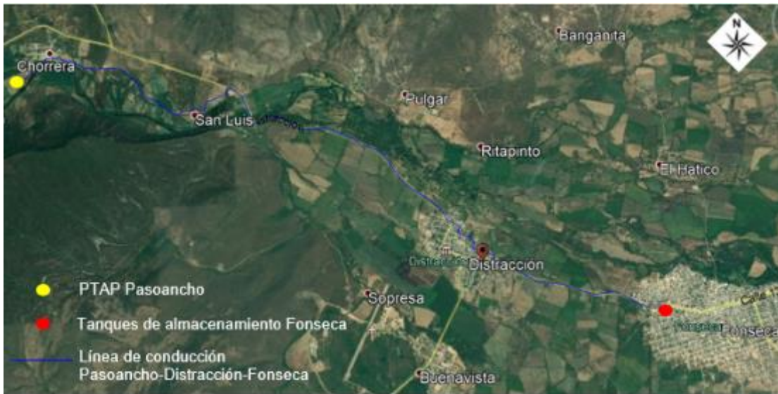
Figura 13. Línea proyectada de conducción Pasoancho – Distracción – Fonseca
