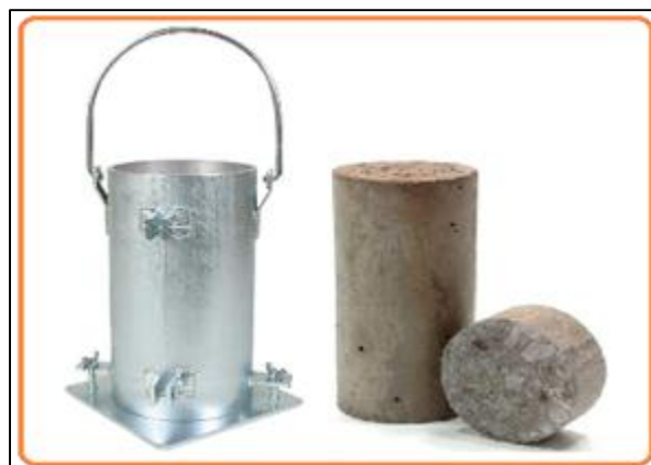
Fotografía 2-14 Cilindros de concreto
