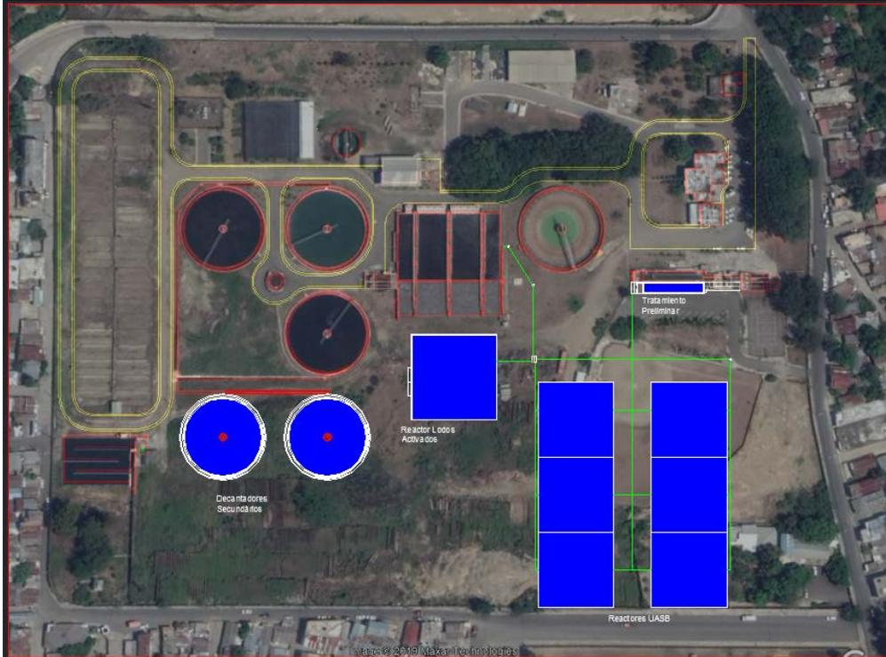
Figura 3-7: Esquema de la ampliación de la planta de tratamiento de Rafey con la Alternativa de RAFA
