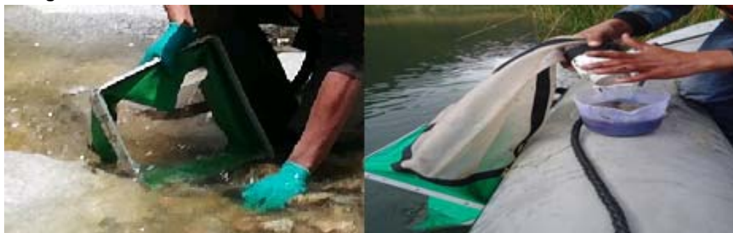
Fotografía 6.2.9.3-1. Muestreo del macrobentos a través del uso de la Red de Surber
