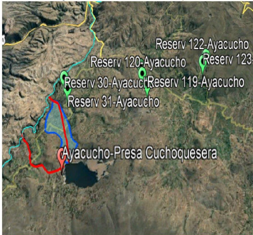
Imagen 3.3.1: Simulación de Rotura de Presa Cuchoquesera
