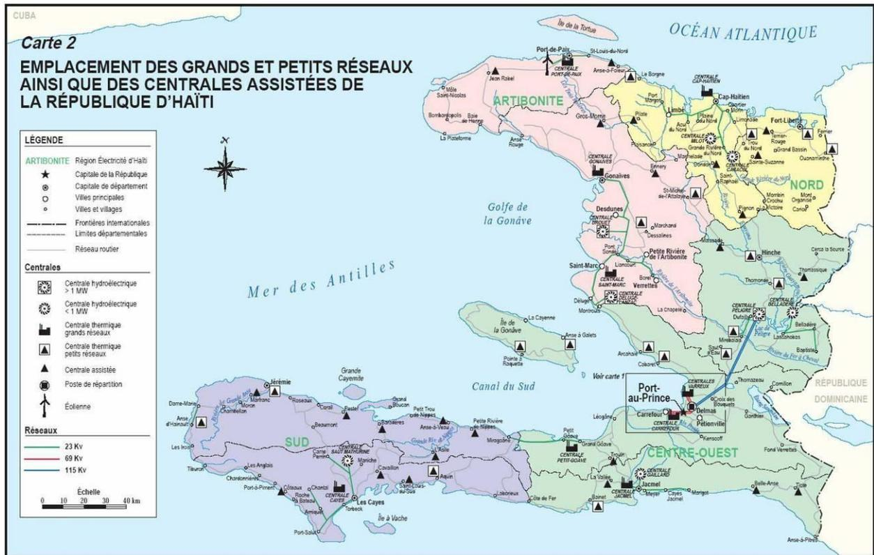
La carte de l'infrastructure de génération et de transport de l'électricité en Haïti ci-dessus montre les réseaux existants en Haïti. Sur cette carte on note la présence des centrales et réseaux électriques excentrés par rapport au réseau principal de Port-au-Prince. Les principaux réseaux concernés par le présent projet sont au Sud : les Jérémie, Les Cayes, Petit-Goâve, Jacmel et La Gonâve, comme indiqué sur la carte ci-dessous.
