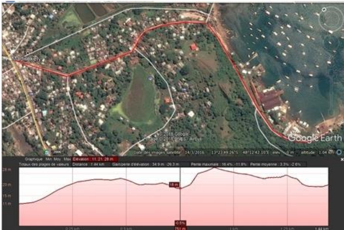
FIGURE 7. PROFIL TOPOGRAPHIQUE LE LONG DE LA ROUTE
