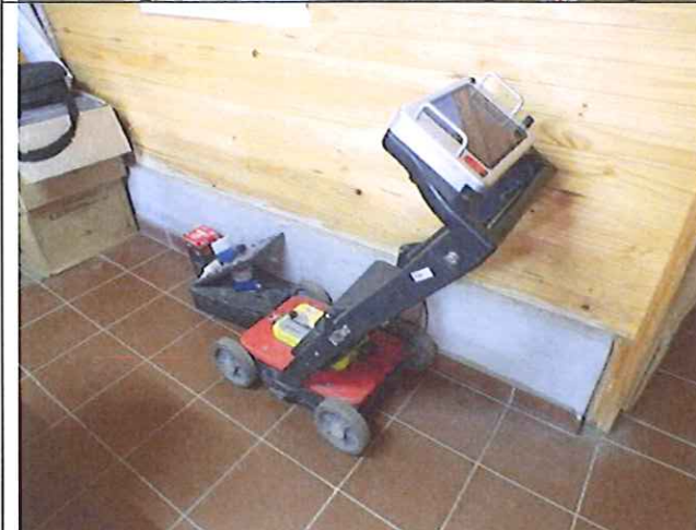
A la derecha instrumento de detección de cañerías enterradas.
