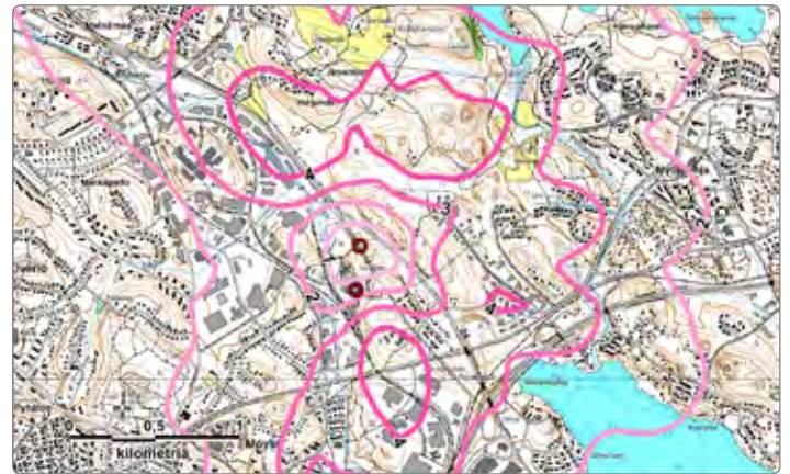
Kuva 19. Bio 2020 voimalaitoksen (100 metrin piippu) ja Kymijärvi II:n SO 2 -päästöjen aiheuttama ulkoilman vuorokausiohjearvoon 80 µg/m 3 verrannollinen SO 2 -pitoisuus koko sääaineistolla, kuvassa pitoisuuden (µg/m 3 ) tasa-arvokäyrät, ○=päästölähde
