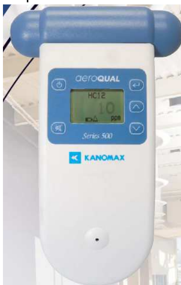
Figure 3 Analyseur de gaz portatif S500, KANOMAX, USA
