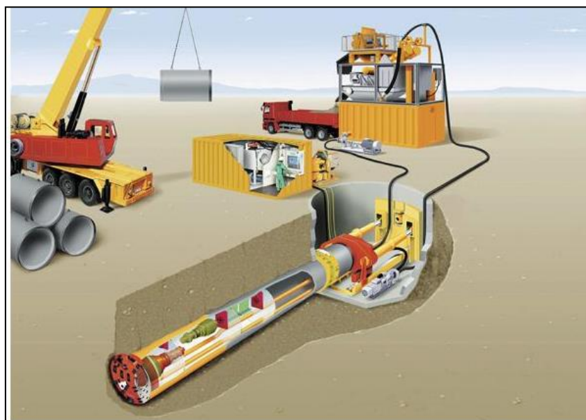
Rycina 20. Schemat metody mikrotunelingu (źródło: http://tunele.inzynieria.com )
