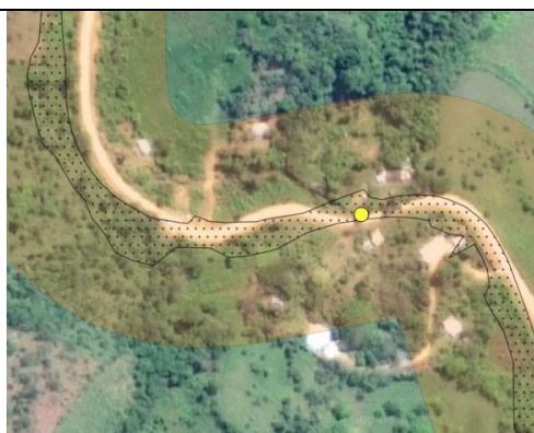
Imagen 2. Sector de Zumba. Aspiran un reconocimiento justo o se evite afectar toda la casa, de ser posible en obra se mueva el eje de la vía y se construyan obras de protección y /o seguridad.
