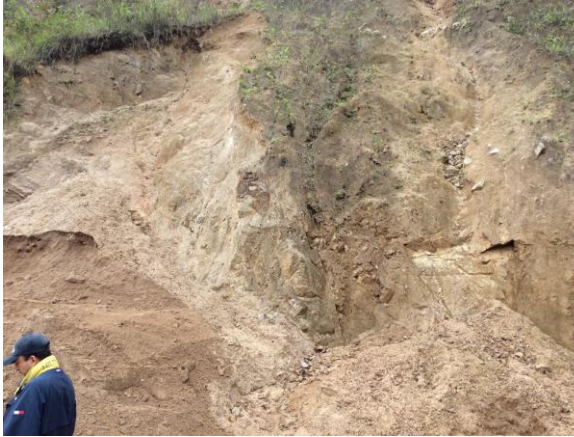
Se ilustra el proceso de deslizamientos remontantes en suelos residuales y horizontes meteorizados de rocas graníticas para el tramo comprendido entre Bellavista y alrededores de El Progreso
