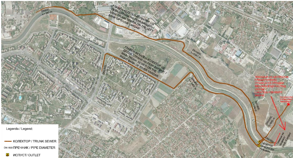
Слика 12. Мапа на фекалниот колектор на левиот и десниот брег на реката Вардар, сифонот и локацијата на ПСОВ (извор: Книга 2 Целосен приказ на преминот со сифон под реката Вардар и поврзување со ПСОВ)
