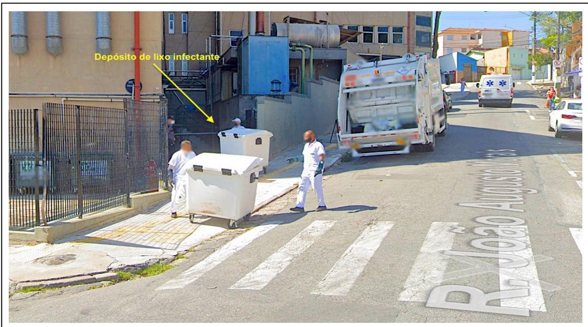
**Figura Nº 31:** Hospital Tide Setúbal. Depósito de resíduo infectante com acesso pela rua João Augusto Moraes. O depósito é inadequado no que se refere à localização e ao acesso, tipo de piso e sistema de drenagem.
