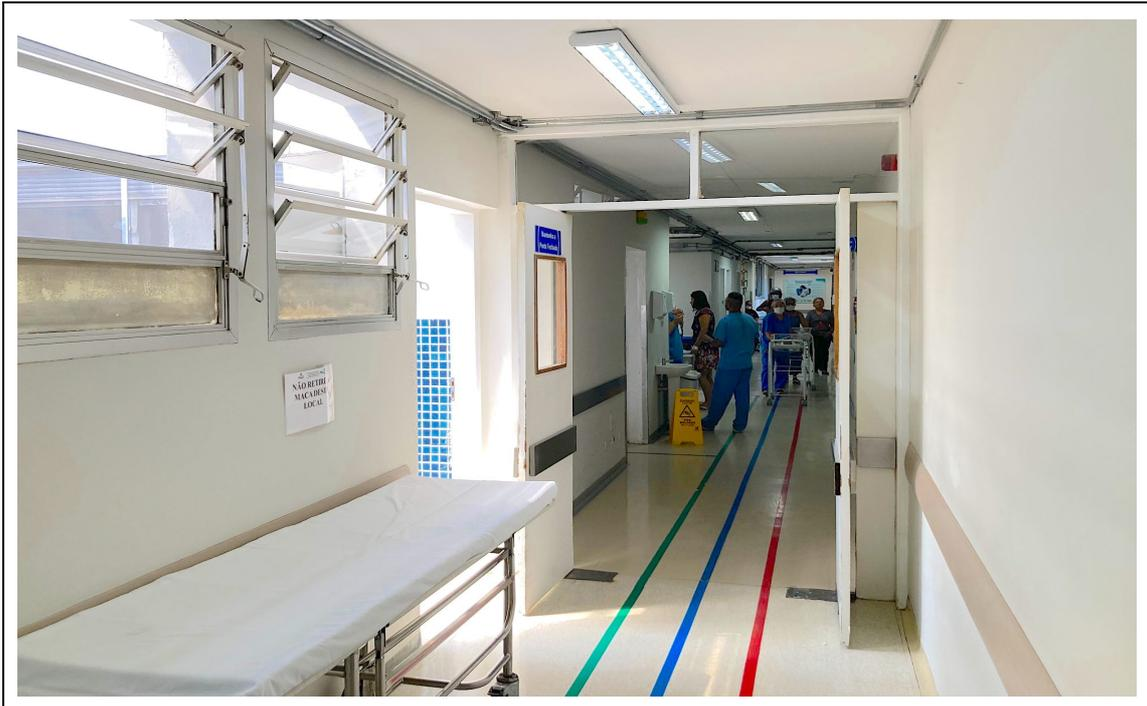
**Figura Nº 41:** Hospital Municipal e Maternidade Mario Degni. Corredor interno em desacordo com as normas e padrões de instalações de serviços de saúde e segurança, sobretudo com relação ao piso, teto, instalação elétrica, identificação de rotas de fuga e implantação de Projeto de Segurança Contra Incêndio e Pânico – PSCIP.
