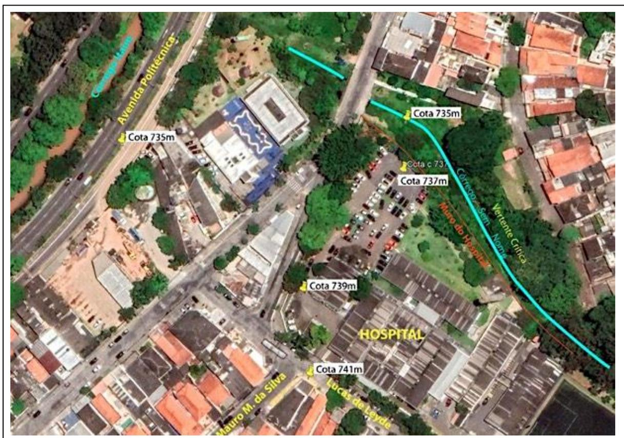
**Figura Nº 80:** O transbordamento do córrego Itaim em episódios de chuvas intensas inunda a avenida Politécnica a esquerda na foto e avança pelo córrego Sem Nome, cujas margens estão na cota 735m, a mesma da avenida Politécnica. Parte do estacionamento do hospital está sobre a cota 737m e as instalações hospitalares na cota 739m (centro da foto).
