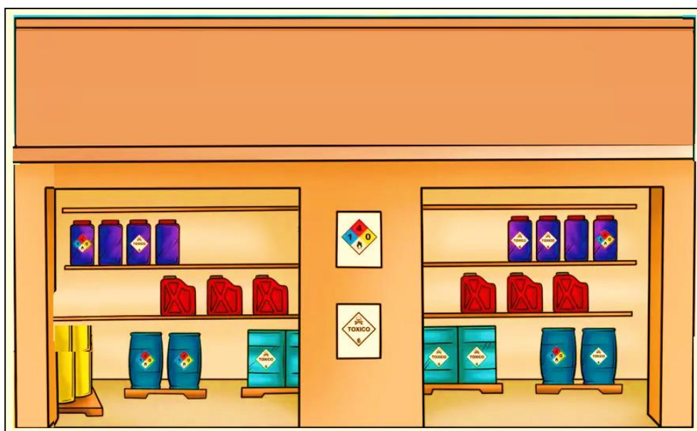
Figura 33. Características área de almacenamiento de residuos peligroso
