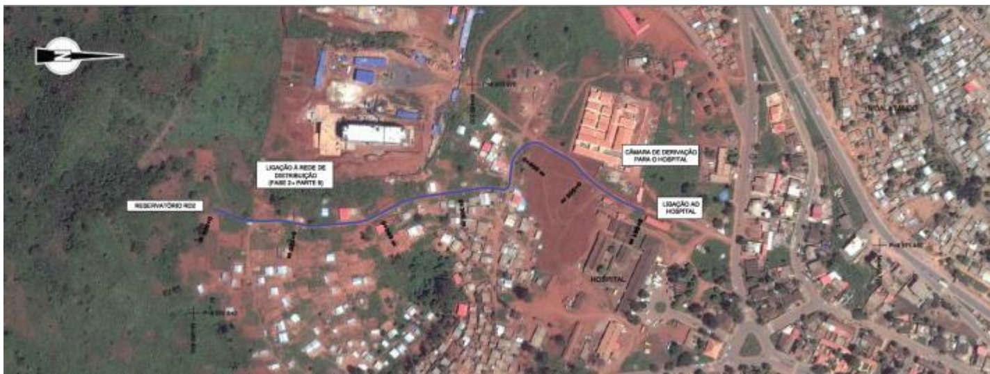
Ilustração 15 – Traçado da Adutora/Distribuidora Gravítica de água tratada do reservatório RD2 até ao Hospital.
