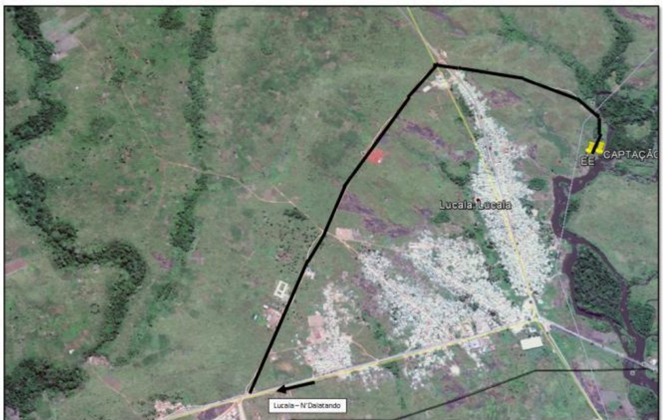
Ilustração 6 - Traçado da conduta elevatória de água bruta até à estrada Lucala - N'Dalatando (através de um caminho de terra batida existente).
