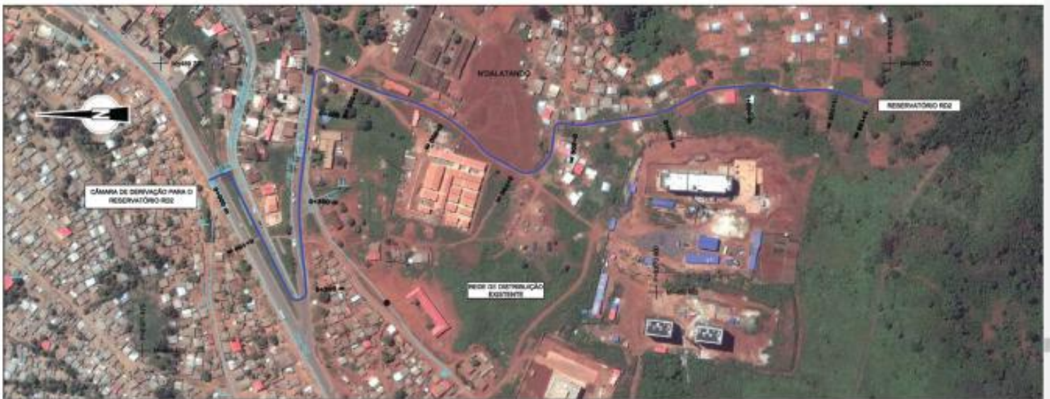
Ilustração 14 – Traçado da conduta adutor de água tratada.
