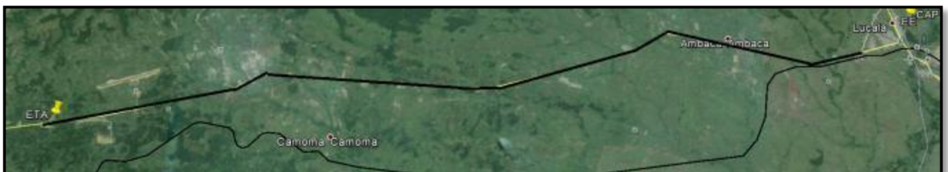
Ilustração 4 - Traçado da conduta elevatória de água bruta no eixo viário da estrada Lucala - N'Dalatando.
