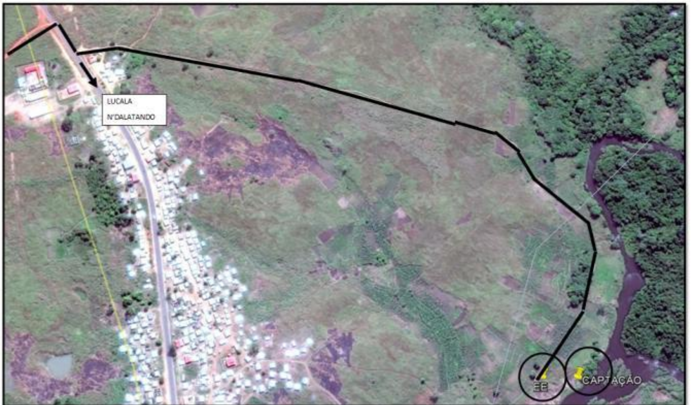
Ilustração 5 - Localização da captação, EE e traçado da conduta elevatória.
