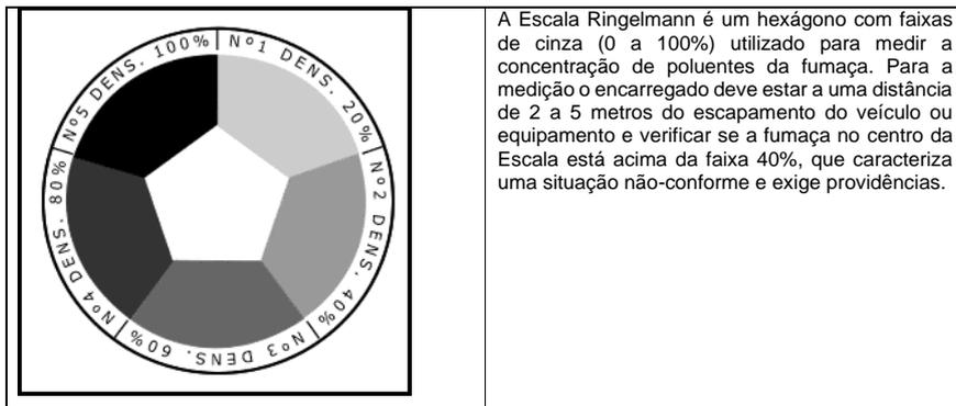
A Escala Ringelmann é um hexágono com faixas de cinza (0 a 100%) utilizado para medir a concentração de poluentes da fumaça. Para a medição o encarregado deve estar a uma distância de 2 a 5 metros do escapamento do veículo ou equipamento e verificar se a fumaça no centro da Escala está acima da faixa 40%, que caracteriza uma situação não-conforme e exige providências.
