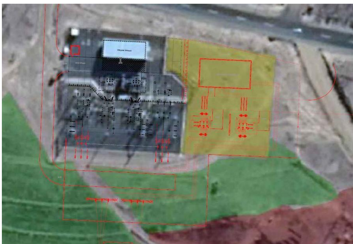
Dessin d'implantation du poste avec GIS.
