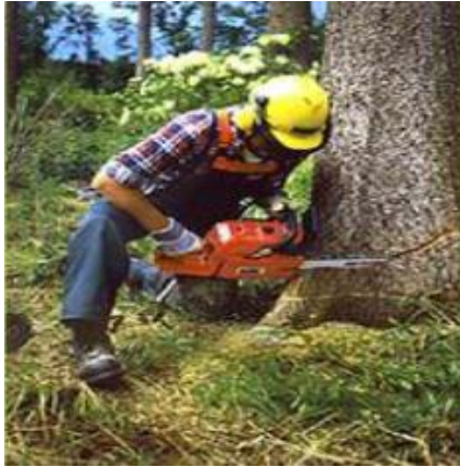
Fotografía 7-3 Corte técnico para aprear un árbol, Observe la altura del corte
