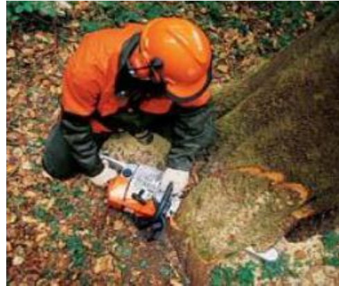
Fotografía 7-4 Corte en cuña para direccionar la caída del árbol
