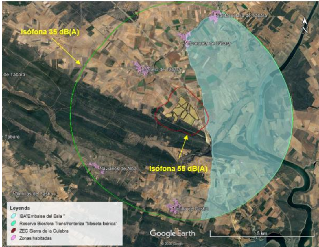
Figura 8.1 Límite de afectación de 55 dB(A) y límite de perceptibilidad de 35 dB(A) durante los trabajos de hincado de los postes de los seguidores.
