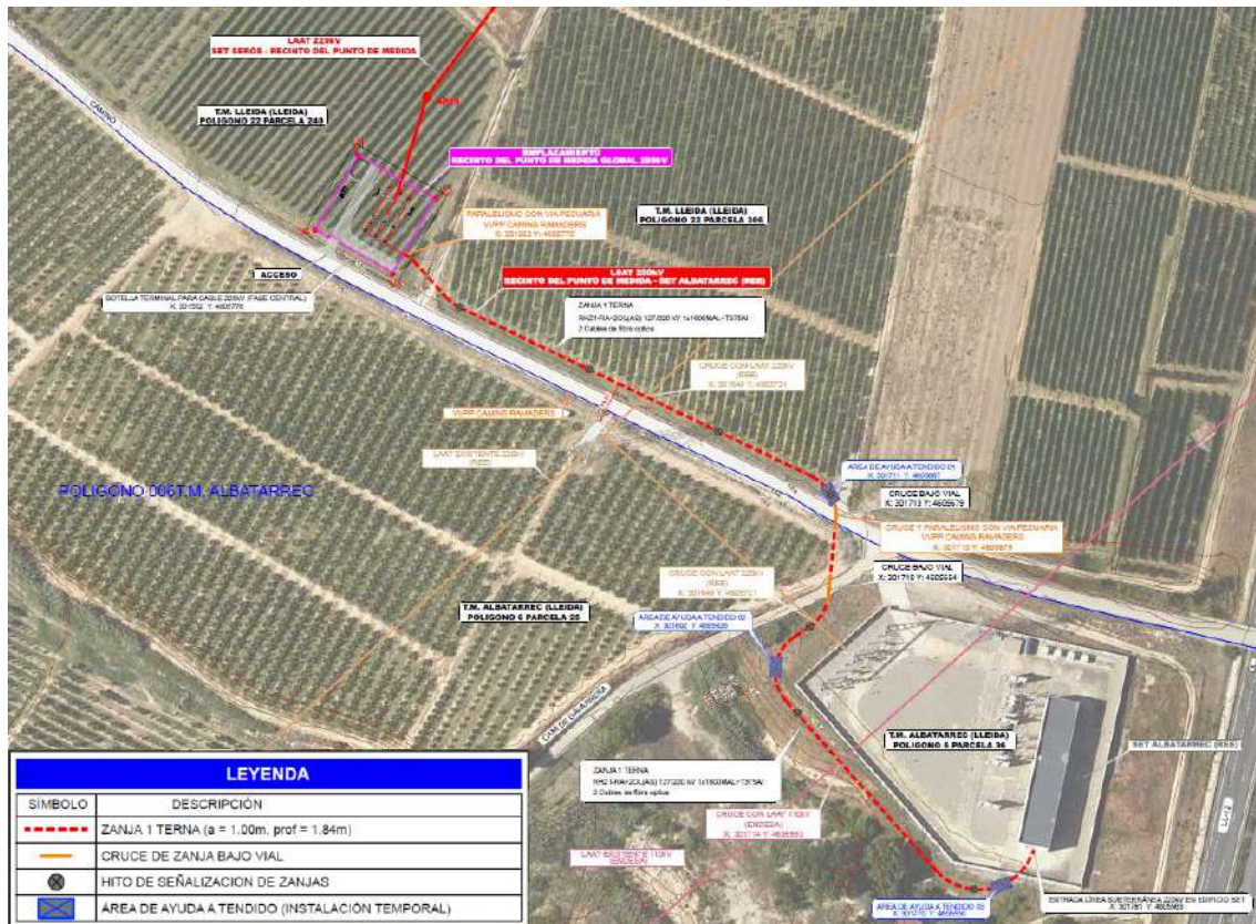
Figura núm. 11. Implantació del Centre de Mesura i la LSAT sobre ortofotomapa.
