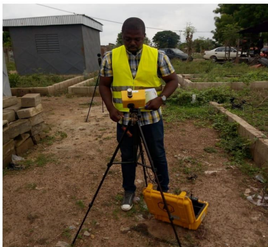
Figure 2 Image illustrant l'étape de mesure des particules de poussière à l'aide du Dumat
