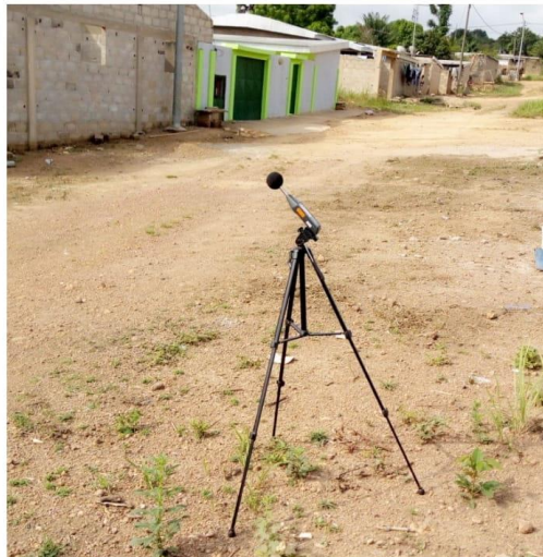
Figure 3 : Mesures des niveaux sonores à l'aide du sonomètre KIMO DB200
