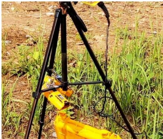
Figure 1 : Image illustrant l'étape de mesures des gaz de combustion dans l'air ambiant à l'aide des détecteurs GASALERT
