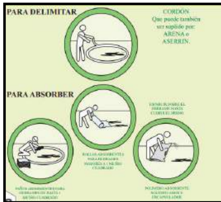
Imagen 8. Pasos para el control de derrame
