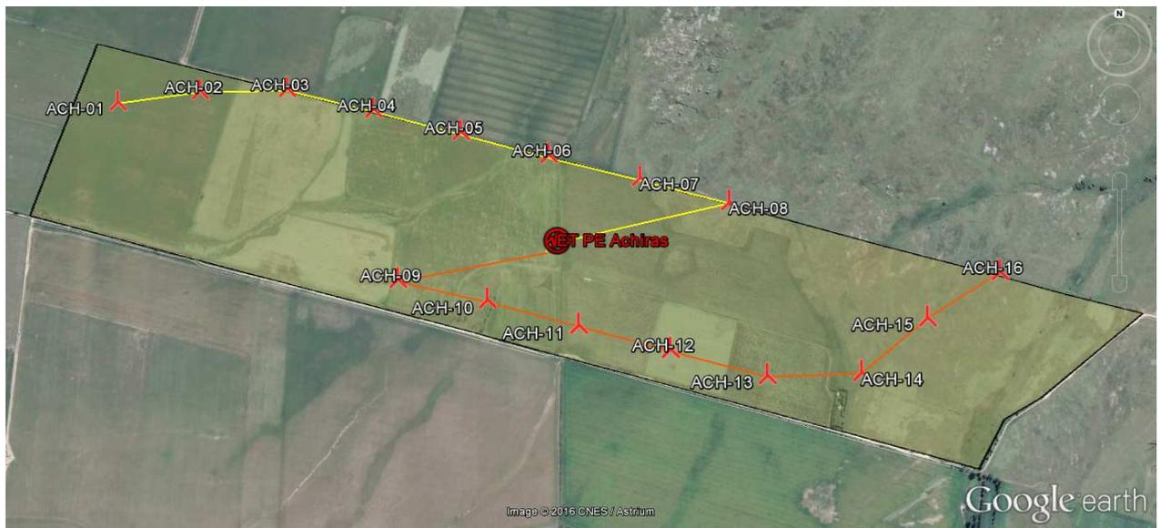
**Figura 3-5.** Detalle de caminos internos, aerogeneradores y ET dentro del polígono del predio.
