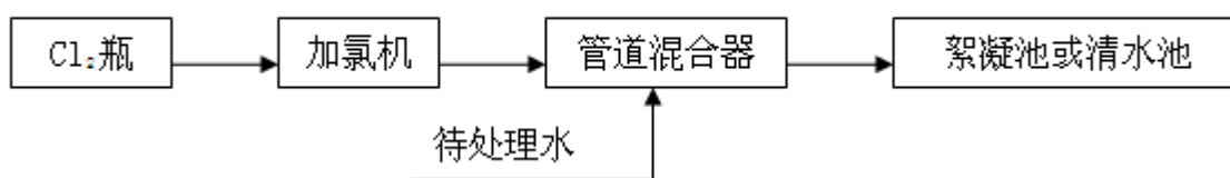
图3.2-1 加氯间工艺流程简图
