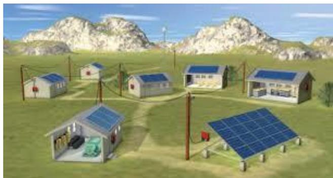
Figure 1. Hybridation avec le solaire photovoltaïque sans stockage d'un réseau alimenté par une centrale thermique
