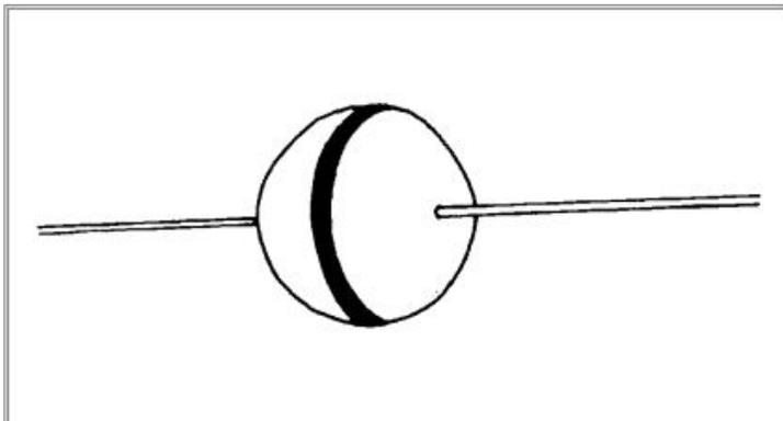
Se soportan al cable de tierra, no requiere de servicio posterior a su instalación, se colocan a cada 75-100 metros, tienen un coste alto con una buena eficacia.
