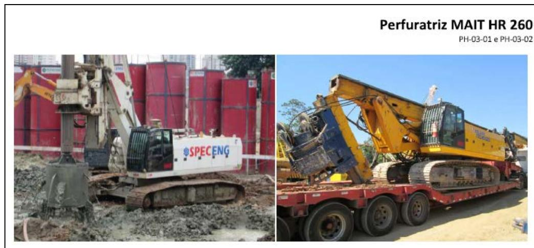
**FIGURA 2-22 - Perfuratriz Utilizada na Execução da Estaca Escavada.**
