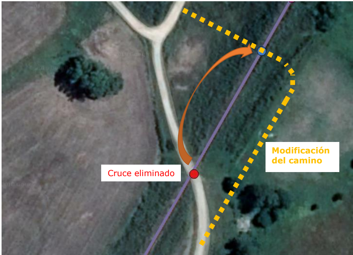
Figura 3-52: Cruce eliminado – Camino público (km 214+687)
