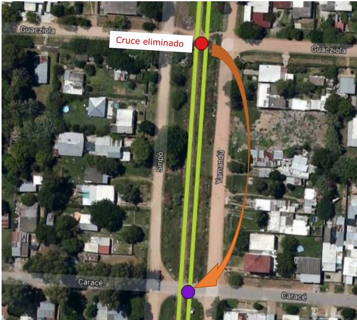
Figura 3-23: Cruce eliminado – Guacziola (km 015+178)
