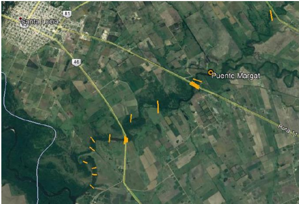
Figura 3-6: Secciones transversales consideradas para el modelo hidrodinámico
