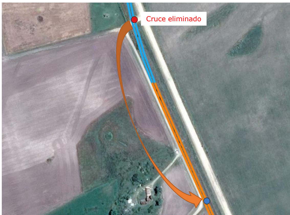
Figura 3-43: Cruce eliminado – Camino privado (km 149+166)
