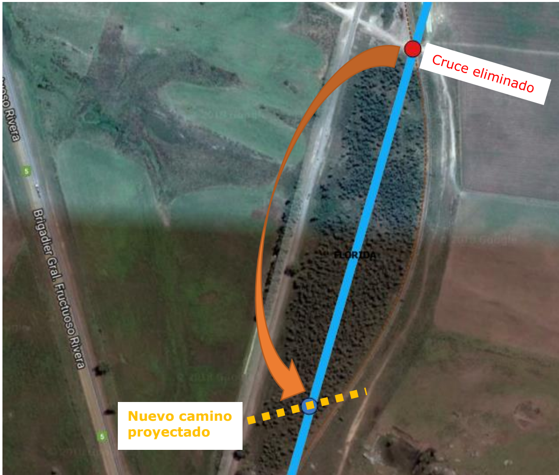
Figura 3-38: Cruce eliminado – Camino agrícola (km 123+427)
