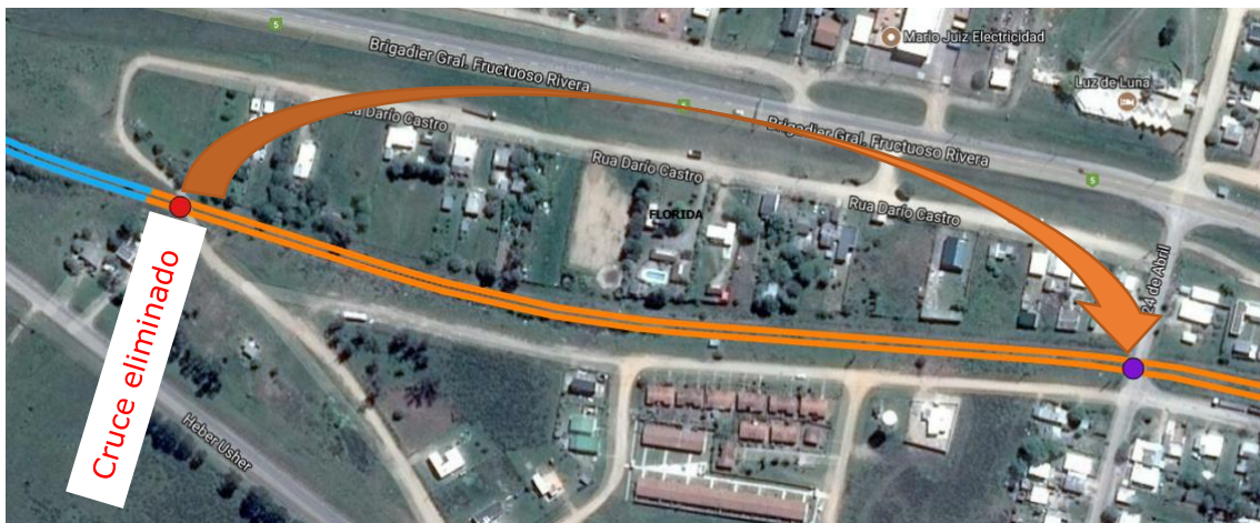
Figura 3-36: Cruce eliminado – Rua Darío Castro (km 108+563)
