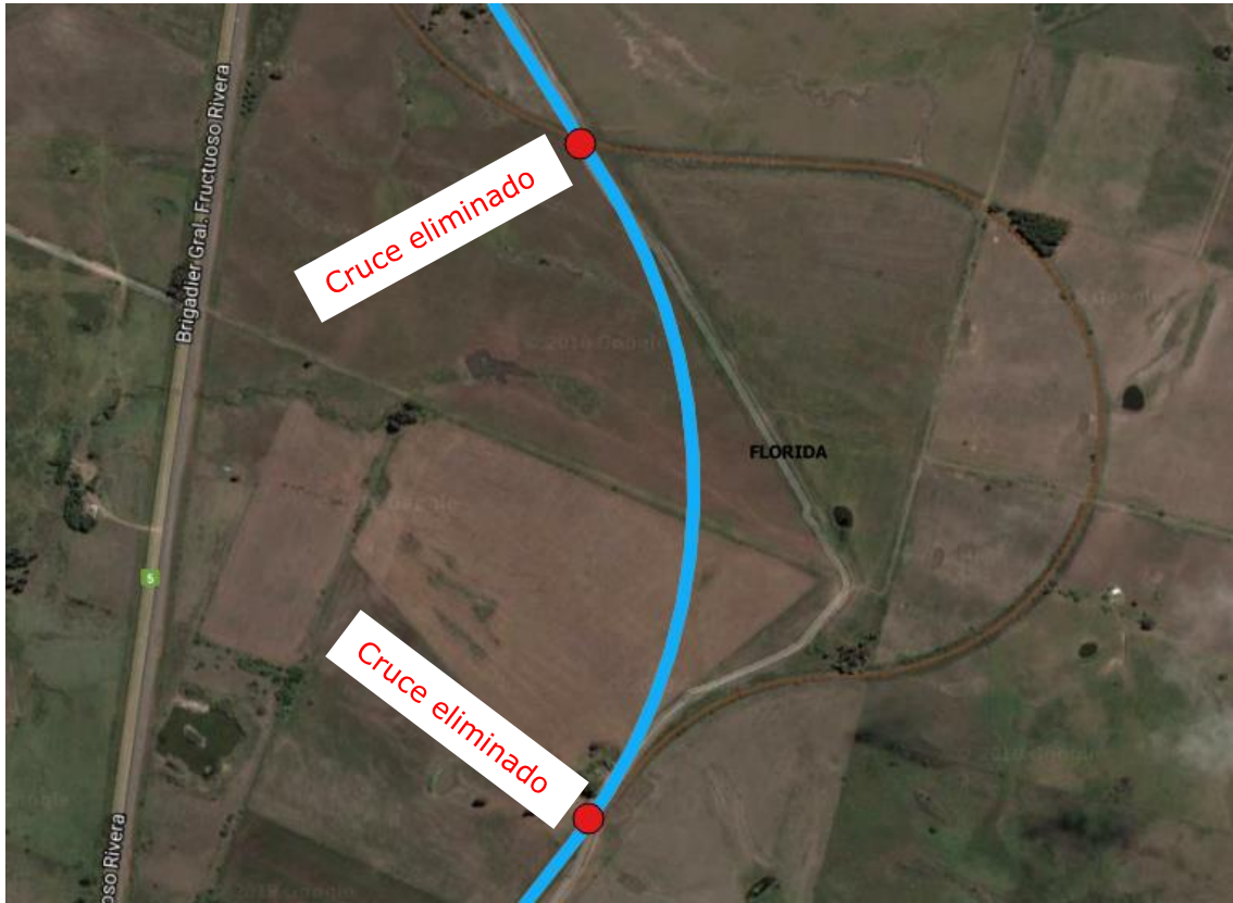
Figura 3-37: Cruces eliminados – Camino agrícola (km 119+981 y km 120+979)
