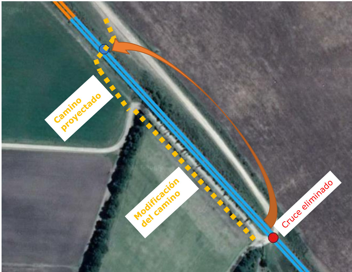
Figura 3-47: Cruce eliminado – Camino público (km 187+275)
