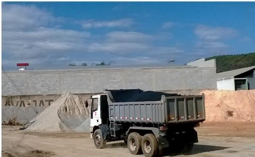
Transporte de materiais em caminhões enlonados
