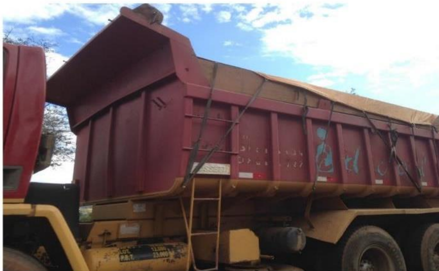
Transporte de materiais em caminhões enlonados
