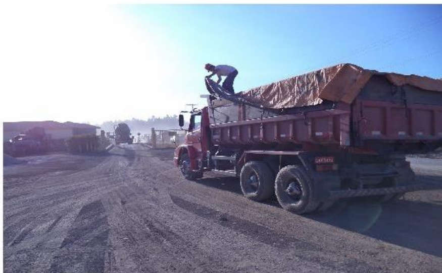
Transporte de materiais em caminhões enlonados
