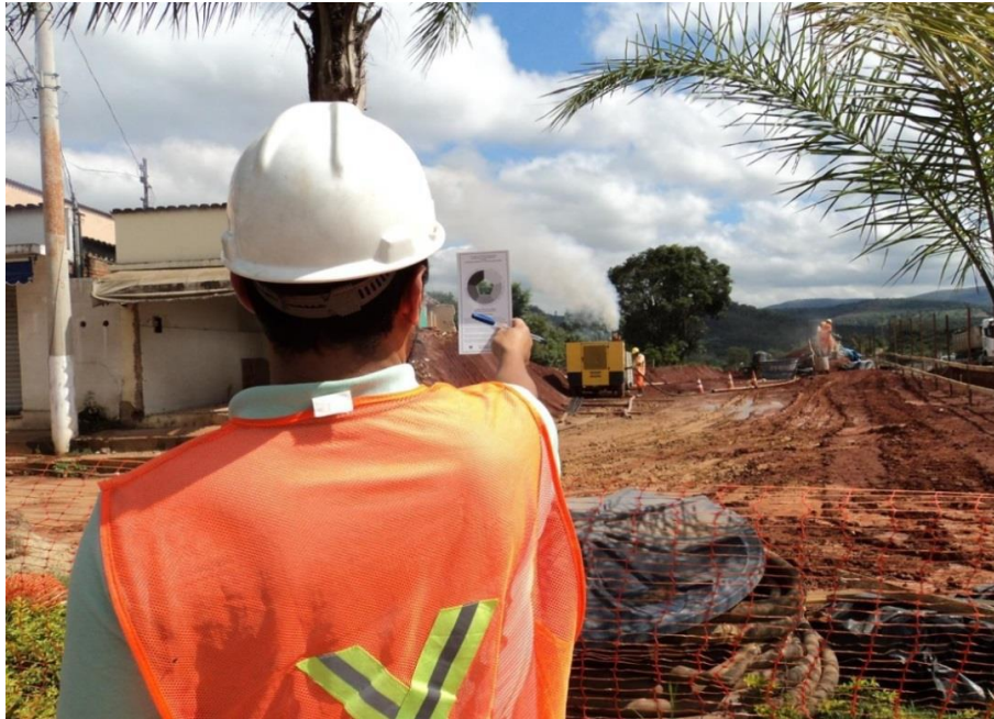
Foto 7.4.3.4-5: Levantamento de emissão de gases poluentes por fonte estacionária.
