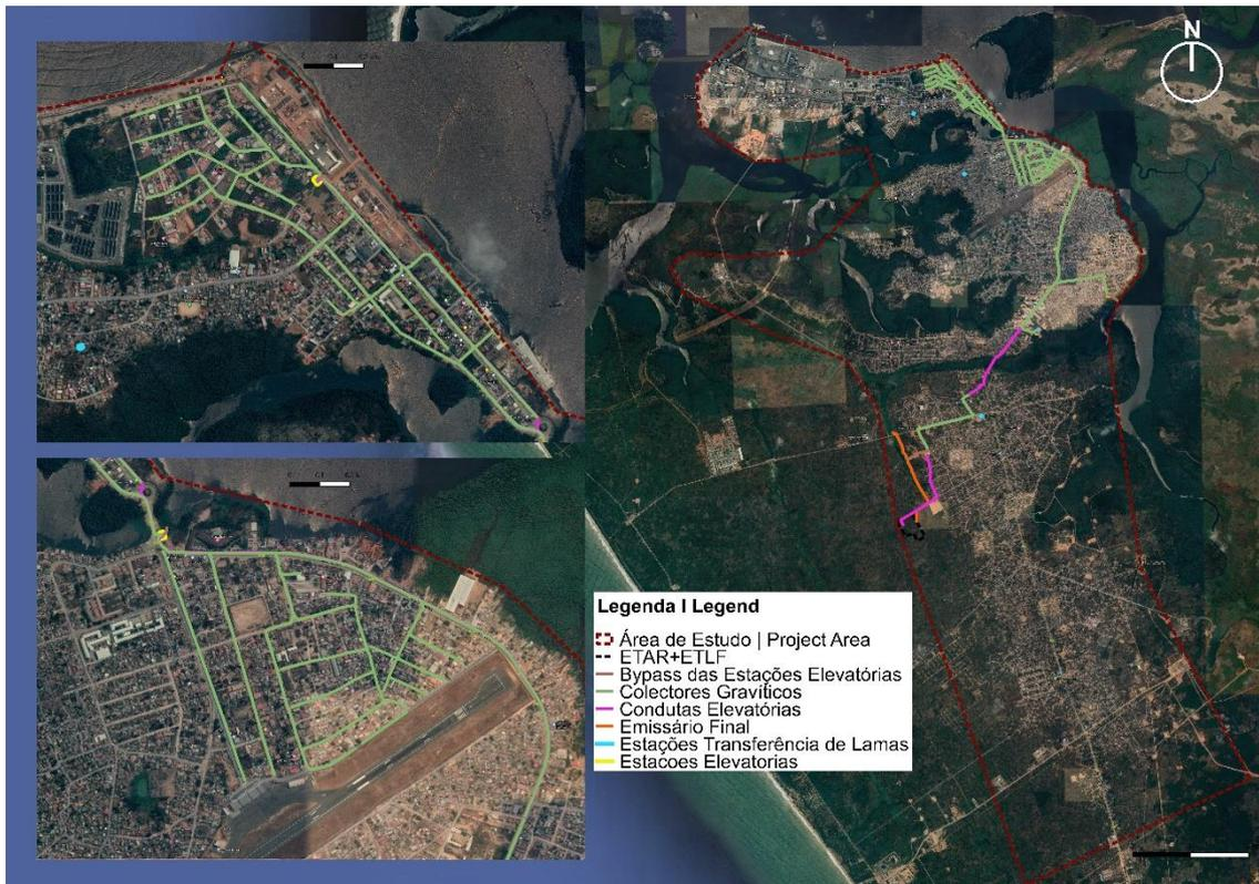
Figura 4.50 - Rede de drenagem (colectores gravíticos, condutas elevatórias, emissários finais, bypass) do projecto
