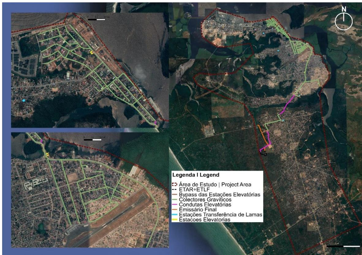
Figura 3.11 - Área de Influência Directa do Serviço de saneamento prestado (rede de drenagem pública + zona abrangida pela recolha e transporte de lamas fecais)
