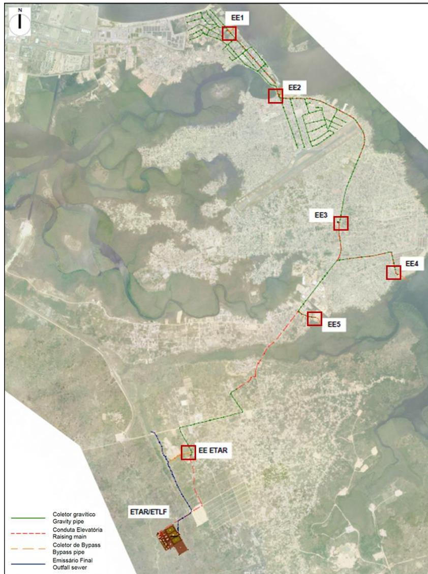
Figura 5.4 – Localização das Estações elevatórias do projecto e respectivas condutas by-pass.
