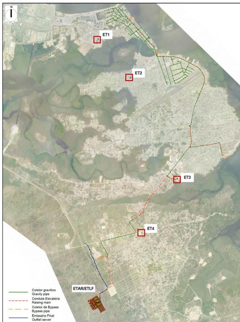
Figura 2.5 – Representação esquemática das Estações de Transferência de Lamas (ET) previstas para Soyo.
