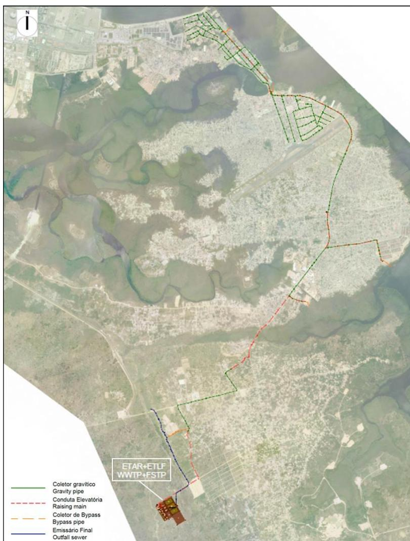
Figura 2.4 – Representação esquemática da solução proposta de saneamento para Soyo.
